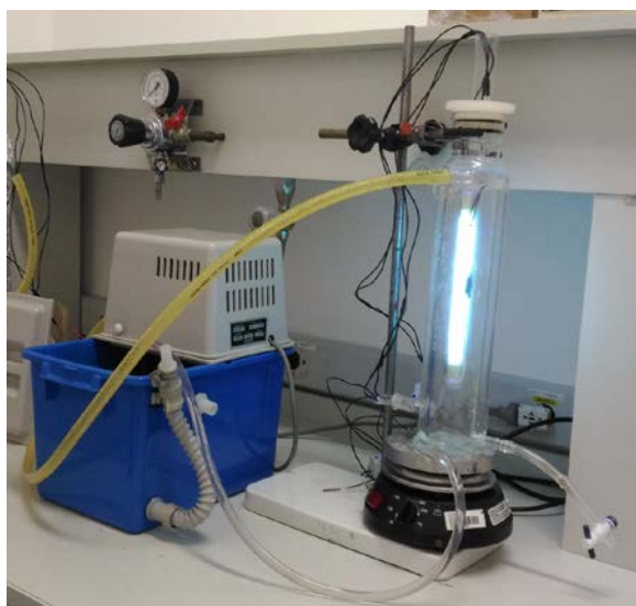
Figura 1: Sistema reacional para fotocatalise
